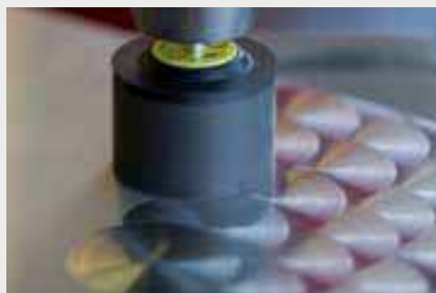
Příklad ozdobného výbrusu s mramorovacím tělískem R-Flex SFM 656 na nerezovém plechu
